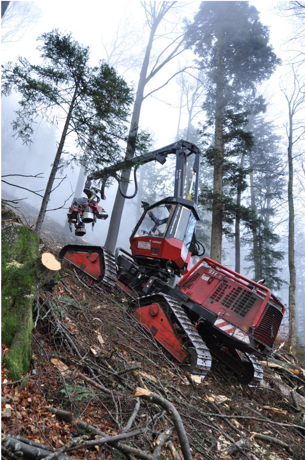
Récolte mécanisée du bois: de plus en plus possible sur des terrains en pente
